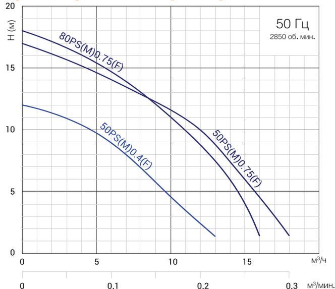
PS: Три фазы; PSM: Одна фаза; PSM...F: Одна фаза с поплавковым выключателем
